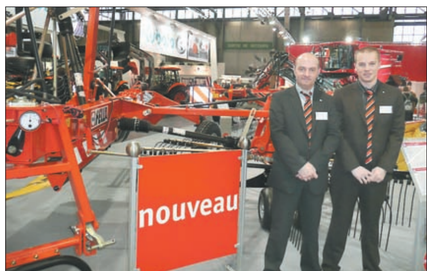
Le TS 880 nouveau turbo-andaineur de la marque Fella est équipé d'un essieu tandem avec des pneus de 18/850-8 ce qui permet un andainage central et une bonne adaptation au sol dans les conditions extrêmes (comme l'andainage de la paille). Ses nouvelles roues lui permettent également une excellente stabilité lors du transport sur route comme au travail.
