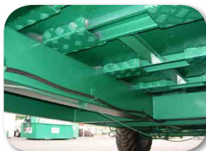
Flèche (timon) de 3m de long soudée jusqu'au ¾ de la bêtaillère
