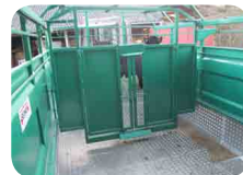
Séparation intérieure sur glissières réglables tous les 50 cm pour isoler ou s'adapter aux gabarits de votre bétail
