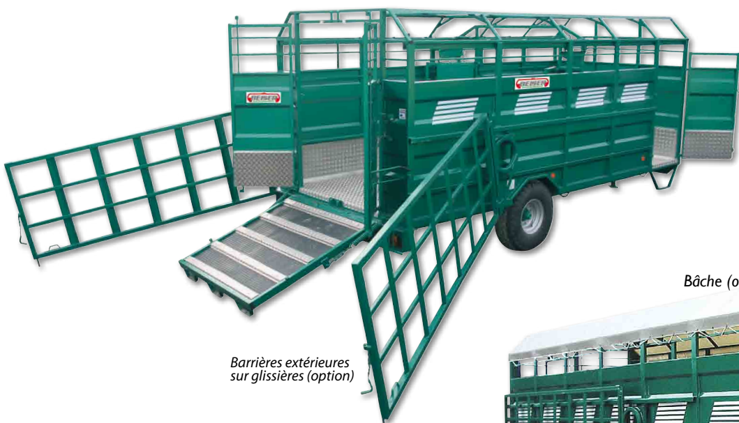
Flèche (timon) de 3m de long soudée jusqu'au ¾ de la bêtaillère
