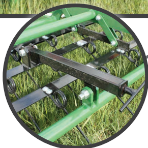
3 rangées de dents souples avec système de réglage de l'angle et de la profondeur de travail
