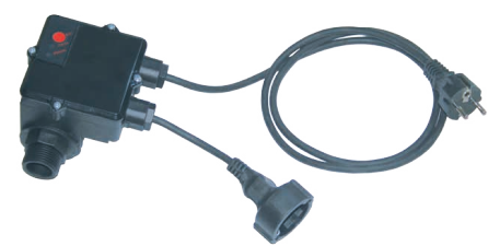
Système automatique d'allumage. Sert à déclencher le démarrage de la pompe. La pression peut être réglée (4,5 bars standard)
