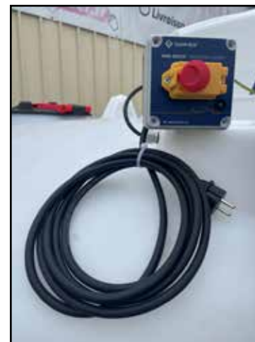
Interrupteur principal et câble électrique 220V
