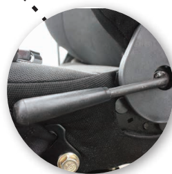
Réglage de l'inclinaison du dossier
