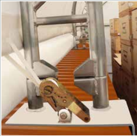
Sangle de fixation et ancrage de la bâche au conteneur
