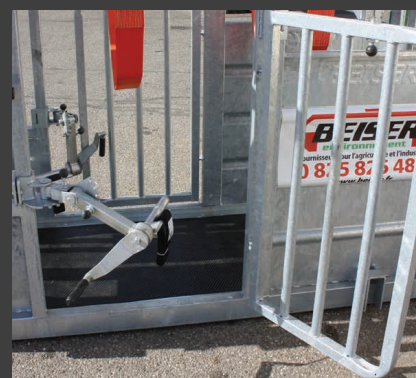
Porte d'accès latéral et treuil de levage des pattes avant
