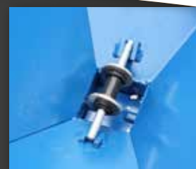
Kit aimants pour éliminer les impuretés métalliques
