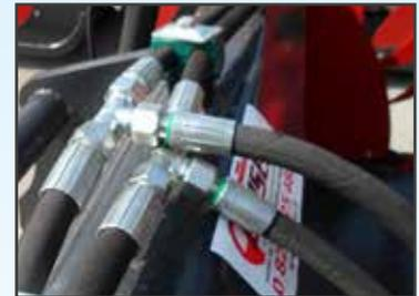
Raccord hydraulique en T (branchement par 2 prises d'huile hydraulique)
