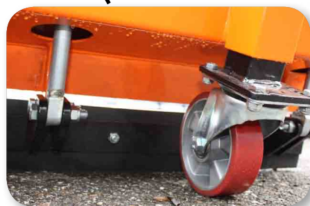
Roues directrices et caoutchouc monté sur ressorts
