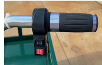
• Poignée d'accélération : > boutons rouges pour la marche avant et arrière, > boutons noirs pour régler la vitesse maximale
