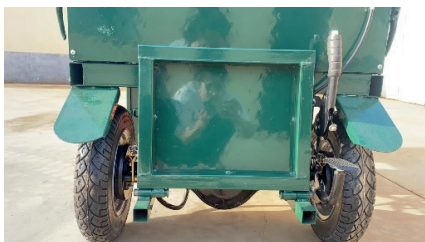
• Le marche-pied peut être rétracté et abaissé pour la conduite (debout ou poussée)
