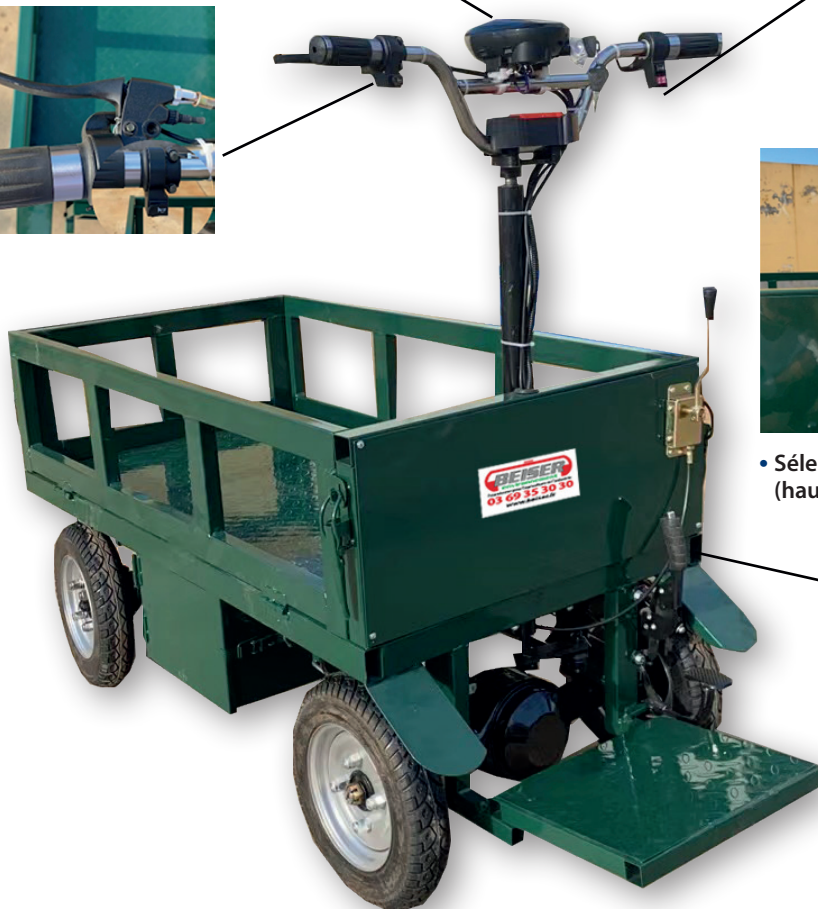
• Poignée d'accélération : > boutons rouges pour la marche avant et arrière, > boutons noirs pour régler la vitesse maximale
