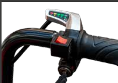
Sélecteur marche av/ar sur la poignée avec indicateur de charge
