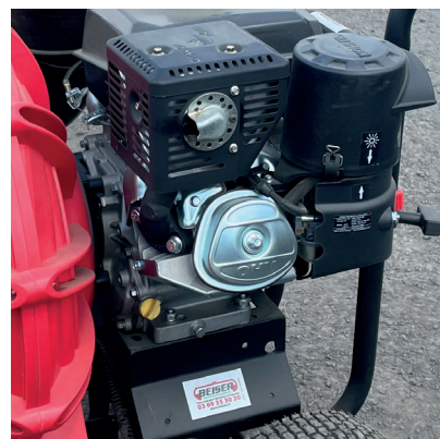
Moteur KOHLER CH440 14HP/10,5KW Quatre temps
