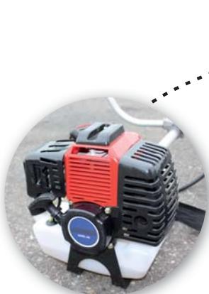
Moteur monocylindre 2 temps avec refroidissement à air et démarrage à tirette
