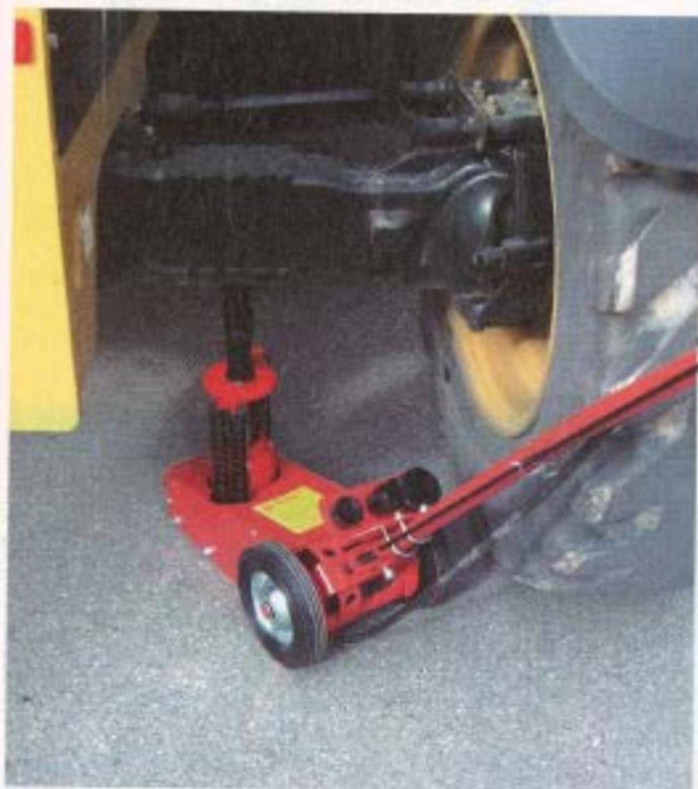
De construction robuste en acier, avec soupape de sécurité (en cas de surcharge), ce cric hydro-pneumatique, de capacité 22 tonnes, possède une poignée blocable en trois positions et est facile à manœuvrer.
