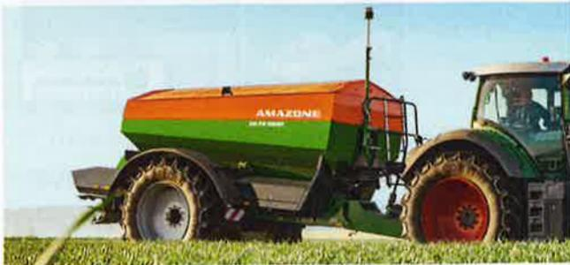
Le système WindControl d'Amazone surveille et compense les effets du vent sur les nappes d'épandage d'engrais. Il mesure en temps réel les caractéristiques du vent durant la projection et modifie en conséquence, pour chaque disque, le point de chute et le régime de rotation. Il alerte l'opérateur en cas de vent trop fort.
