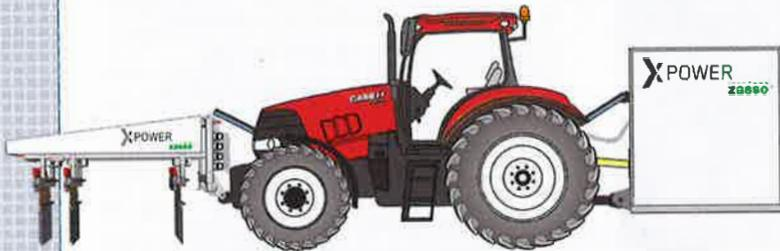
Le dispositif d'herbicide électrique connecté XPower de Case IH électrocute les adventices de l'interrang jusqu'aux racines et assure ainsi un désherbage total. L'outil évalue en permanence les données pédoclimatiques et ajuste la tension appliquée aux mauvaises herbes, ainsi que la vitesse d'avancement grâce à une liaison Isobus de classe 3.
