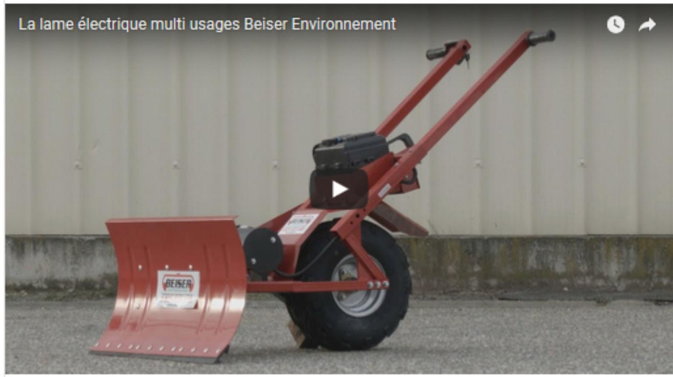
La lame électrique multi-usages est une petite machine légère qui permet à son utilisateur de déblayer seul et rapidement de grandes surfaces avec une poussée maximale de 70kg.
